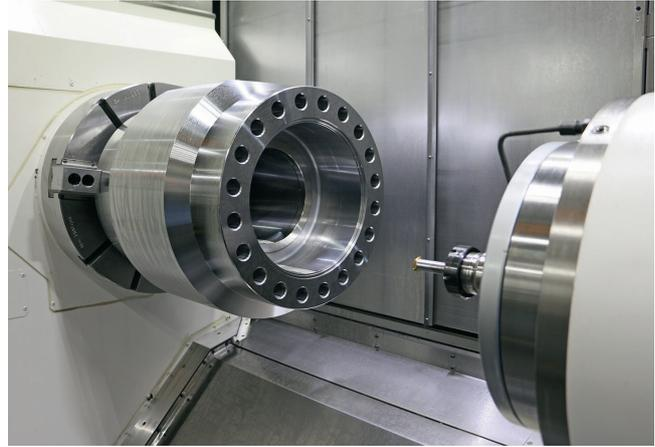
3 Auf einer Okuma Multus B550 werden bei Schröder in das Untergehäuse jedes Freilaufschlägventils 20 Gewinde eingebracht
